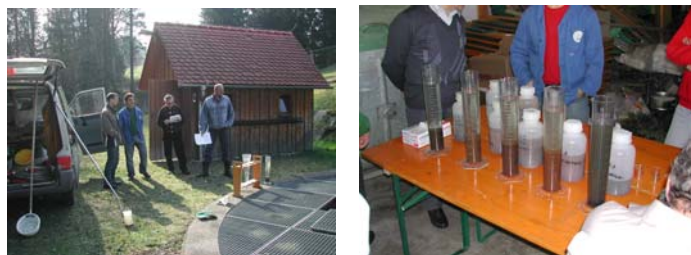
Praktische Übungen / Schnelltests, Bestimmung von Schlammvolumen
