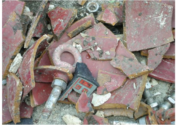
Abb. 2: Teile des zerstörten Entlastungsventils und des Gaswarngeräts
