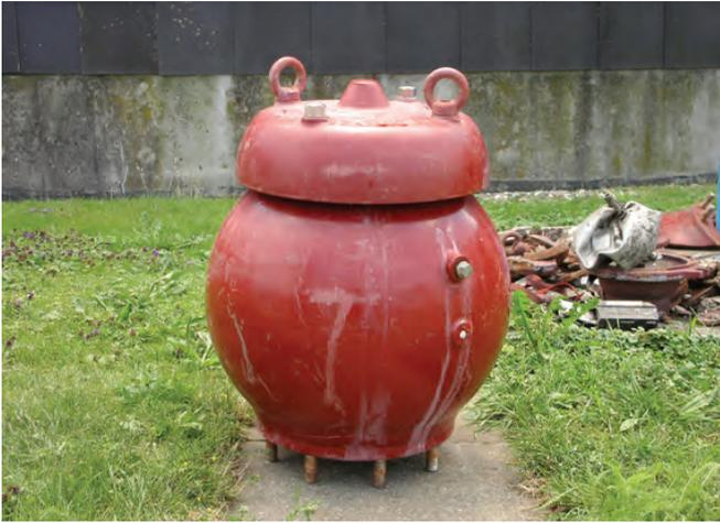
Abb. 1: Entlastungsventil nach dem Ausbau (Gewicht ca. 100 kg)
