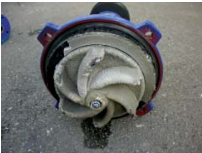
Abb. 3: Da freut sich der Wirkungsgrad – das Laufrad der Zentratpumpe
