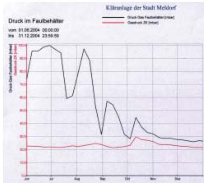
Abb. 4: Gasdruck im Faulbehälter
