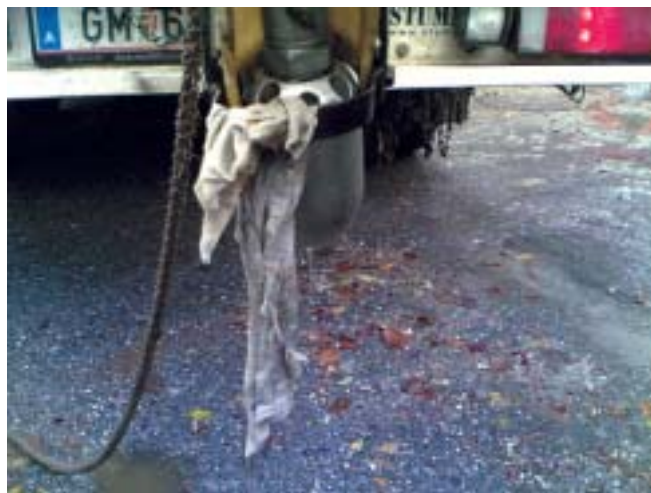
Abb. 6: Wieder ein Tuch am Kanalspülgerät
