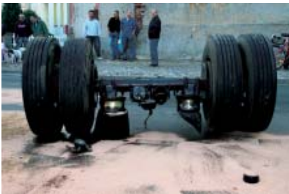
Abb. 1: Die Hinterachse des Anhängers hat sich selbstständig gemacht
