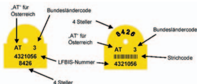
Abbildung 1: Gestaltung der Ohrmarke für Schweine
