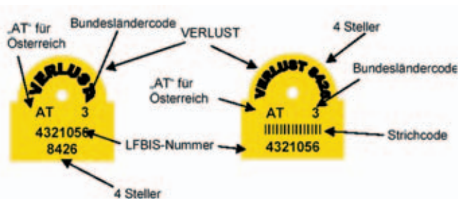
Abbildung 2: Gestaltung der Ersatz-Ohrmarke für Schweine
